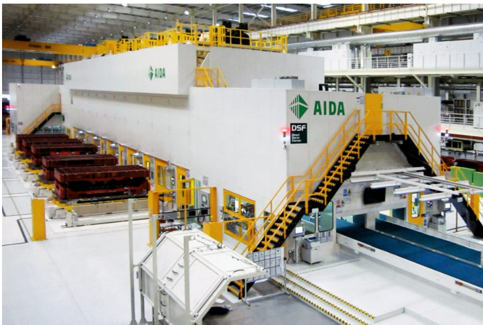
Tandem-Pressenstraße in einer Automobil-Fertigungsstätte (Bild: Aida Engineering,
