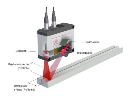
Funktionsprinzip eines Laserscanners (Bild: Micro-Epsilon).
