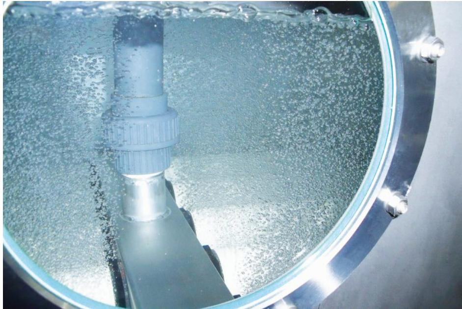
Feinblasige Luftverteilung bei der Wasseraufbereitung. Gelangt CO<sub>2</sub>-haltiges Wasser in Kontakt mit Luft, geht das CO<sub>2</sub> in die Luft über (Bild: Aquadosil).
