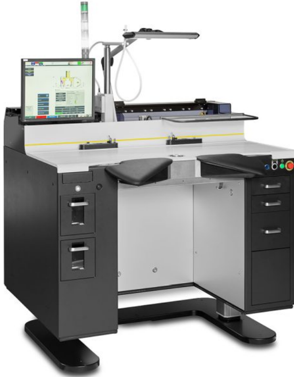
Montagestation für Uhrwerke. Im Innern verbirgt sich eine Montagefabrik im Miniaturformat (Bild: Precitrame).
