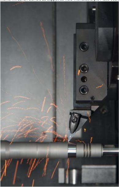
Die abgestimmte Kombination von Schnittgeschwindigkeit und Werkzeuggeometrie schmilzt die harte Außenhaut des Werkstücks auf, die dann zerspant wird (Bild: Walter AG).
