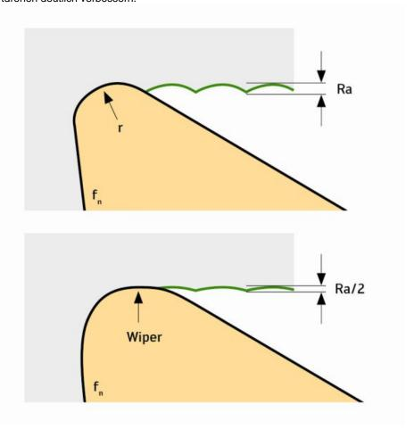
Durch den Einsatz der neuen Wendeschneidplatte mit Wiper-Schneide halbiert sich der Mittenrauwert der bearbeiteten Oberfläche (Bild: Walter AG).
