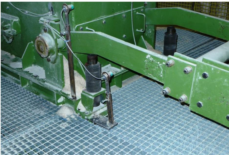
Mit Industriestoßdämpfern von ACE ausgestattete Schwenkarme an den Rolollochklappen machen die Füllprozesse effizienter (Bild: Technischer Handel Schenk, K+S Kali GmbH).
