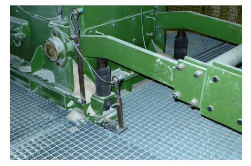
Mit Industriestoßdämpfern von ACE ausgestattete Schwenkarme an den Rolllochklappen machen die Füllprozesse effizienter (Bild: Technischer Handel Schenk, K+S Kali GmbH).
