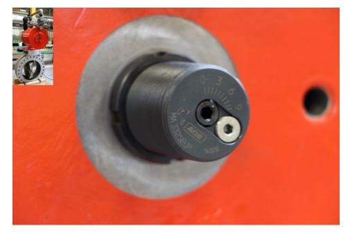
Von der Doedijns Group International (DGI) konstruierter Aktor mit integriertem, einstellbarem ACE-Industriestoßdämpfer für ein Kompressorpaket einer Erdgasraffinerie (Bild: DGI).
