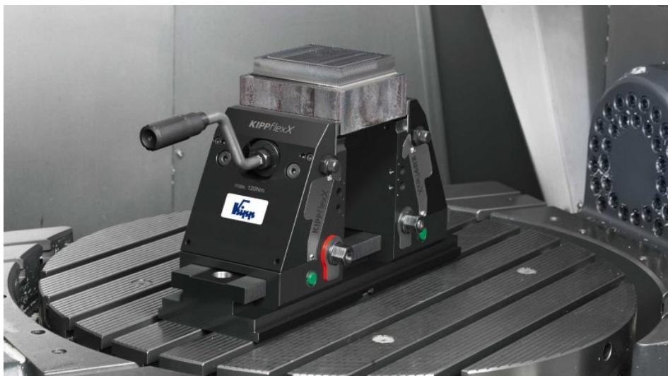
Der neue 5-Achs-Spanner vereint eine Niederzugfunktion mit der Funktionsweise eines Standard-Schraubstocks (Bild: Kipp).
