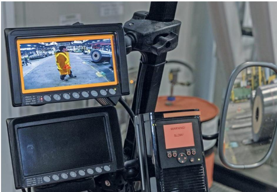
Das 3D-Kollisionswarnsystem für mobile Arbeitsmaschinen hilft dabei, Unfälle zu verhindern (Bild: ifm).
