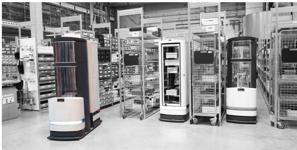
Der Logistik-Roboter »Toru« kombiniert autonomes Fahren mit Handlingsrobotik. Sowohl das Ausfahren der Zunge als auch das Bewegen des Greifarms übernehmen bürstenlose DC-Servomotoren von Faulhaber (Bild: Magazino).
