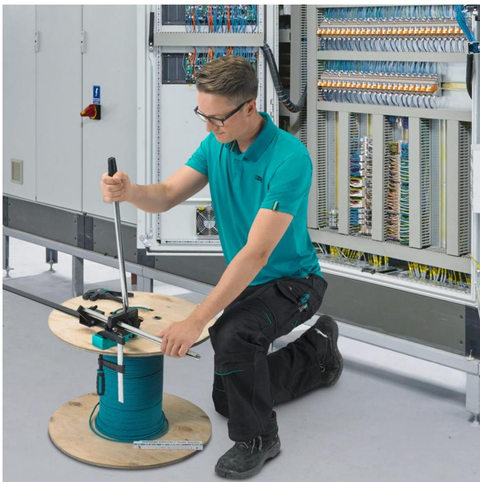
Durch sein geringes Gewicht kann der Tragschienenschneider auch auf der Baustelle eingesetzt werden (Bild: Phoenix Contact).
