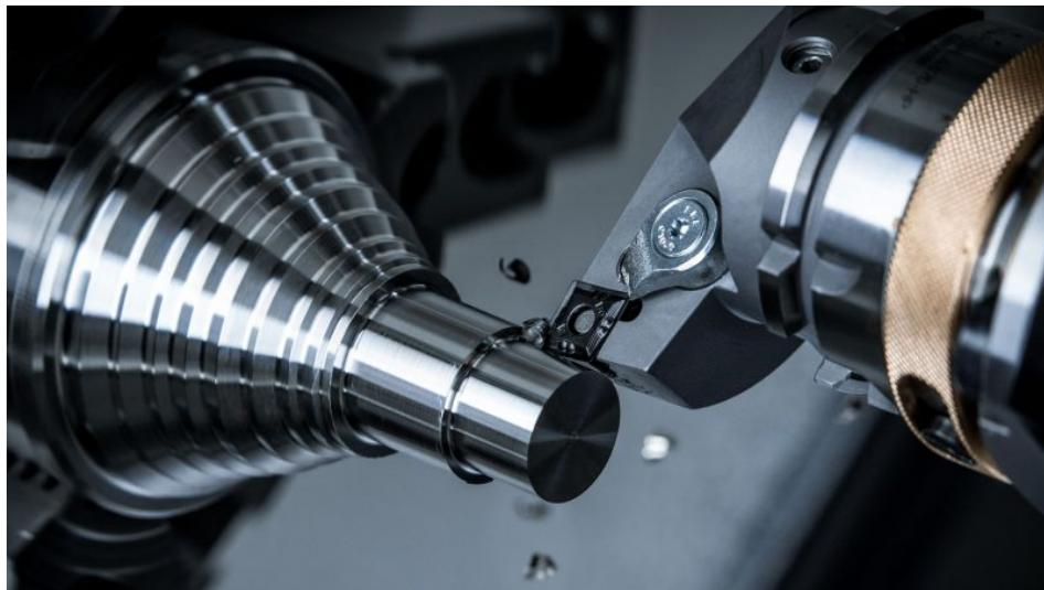
Mit den neuen Schneidstoffen werden nahezu alle Anwendungsbereiche in der Bearbeitung von austenitischen rostfreien Stählen abgedeckt (Bild: Ceratizit).
