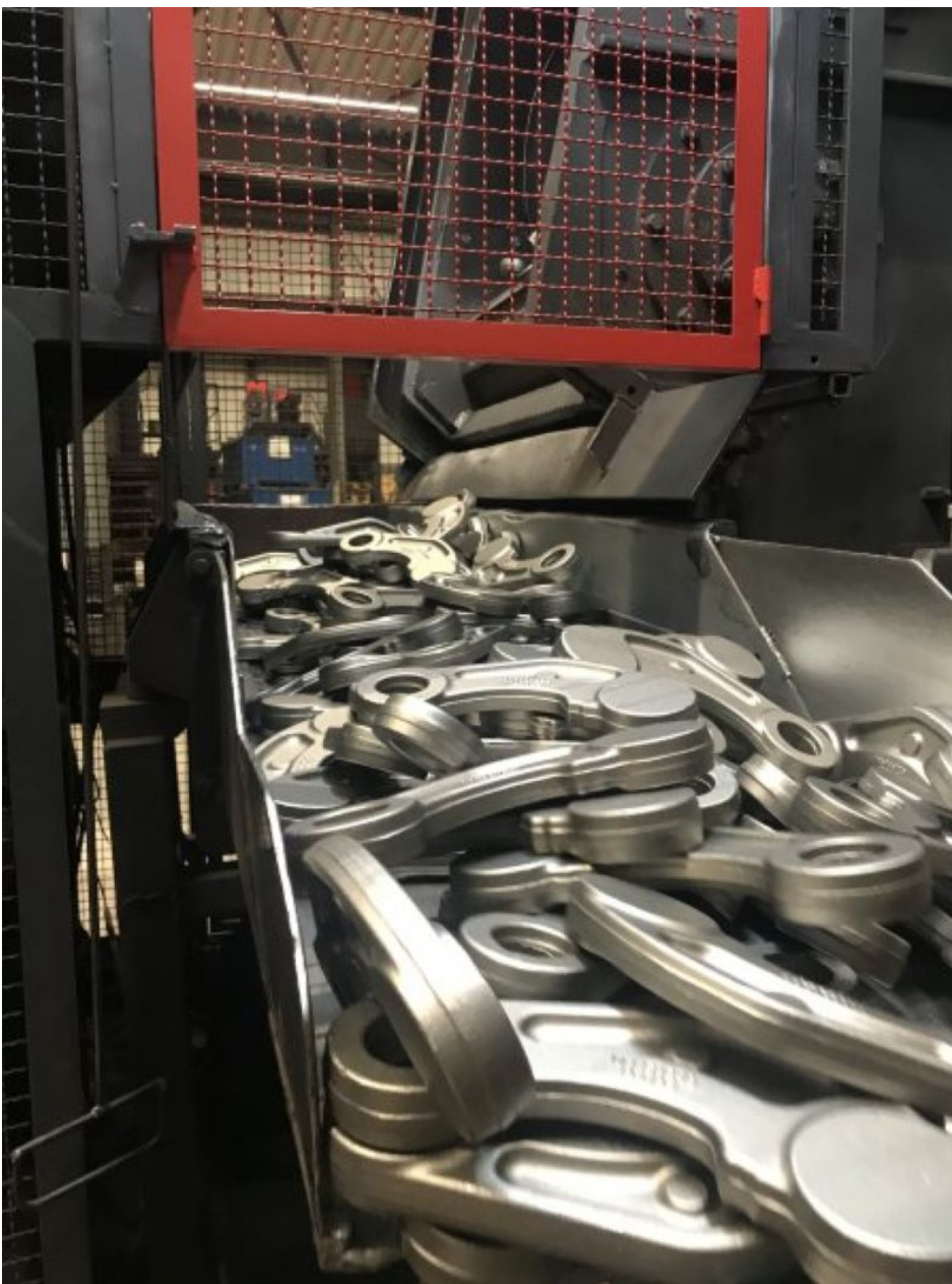
Gestahlte Schmiederohlinge in der Austragsrinne der Muldenbandstrahlanlage (Bild: KST Kugel-Strahltechnik).
