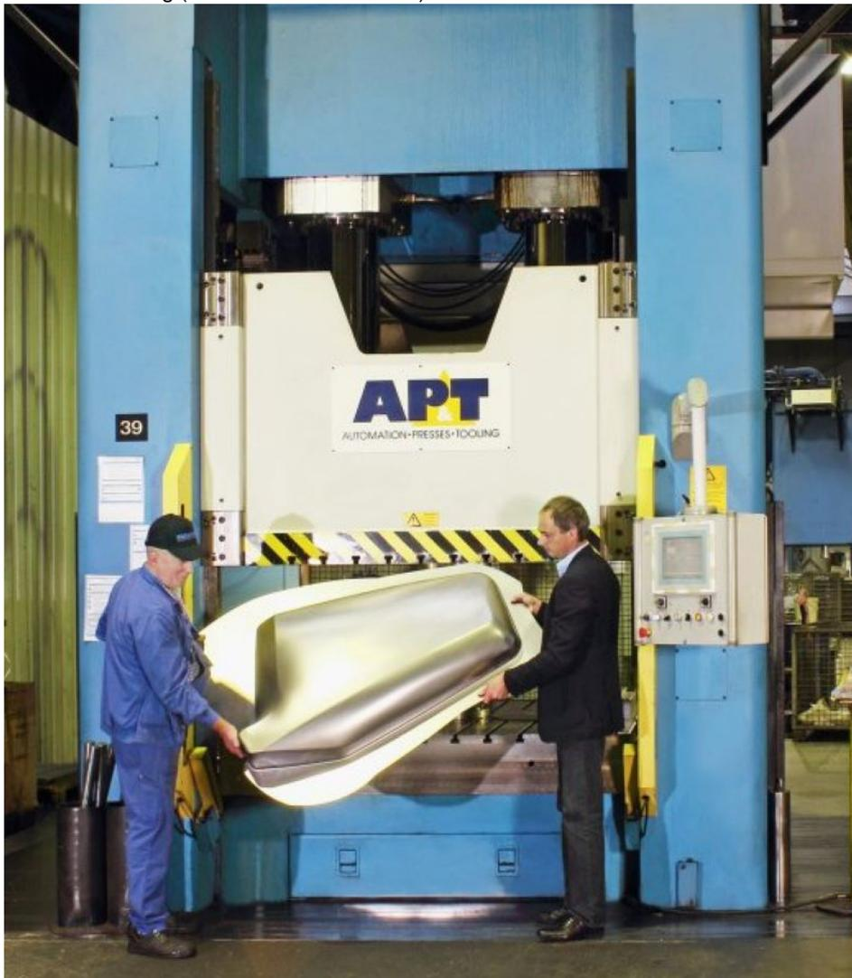
Bei größeren Stückzahlen kann vom Metalldrücken auf das Tiefziehen nach DIN 8584
