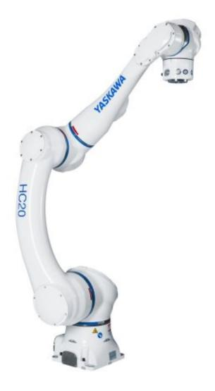
Der Cobot mit dem maximalen Handlingsgewicht von 20 kg erweitert die Anwendungsmöglichkeiten (Bild: Yaskawa).
