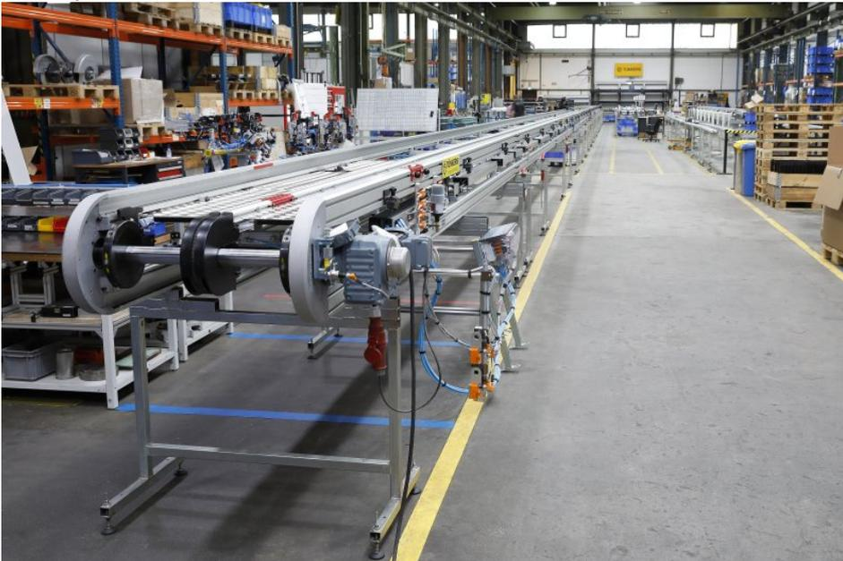
Der 63 m lange Stauförderer für Karosserieteile konnte innerhalb einer Woche montiert werden (Bild: Tünkers).
