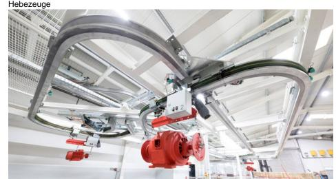
Dank intelligenter Konstruktion werden Elektrohängebahnen auch für den Mittelstand interessant (Bild: SEH Engineering).
