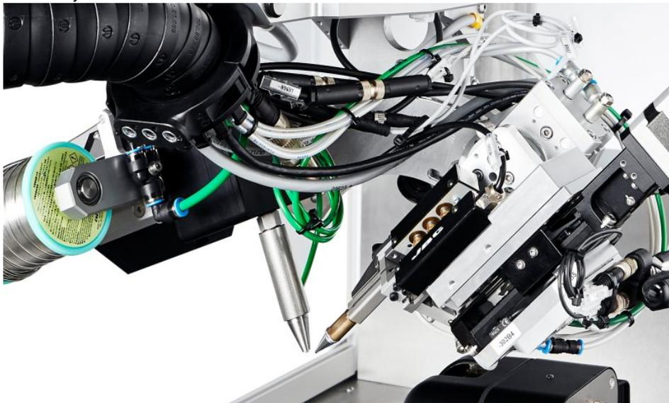
Die Lösung zum Kolbenlöten basiert auf der Plattform »MPC«, in der ein Robotersystem zum Einsatz kommt (Bild: Eutect).
