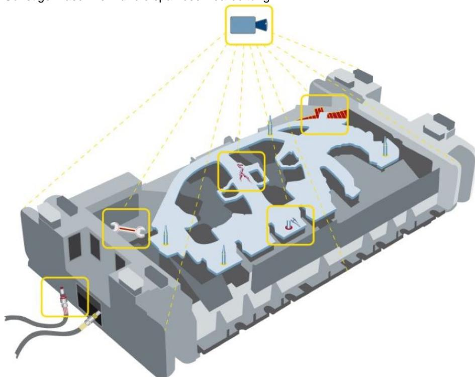
Die Kameras des Überwachungssystems entdecken Fremdkörper, fehlende Anschlüsse oder Beschädigungen (Bild: Schuler).
