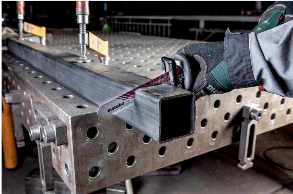
Mit den Sägeblättern aus Hartmetall sind schnelle, gerade Schnitte auch in dicken Materialien kein Problem (Bild: Metabo).
