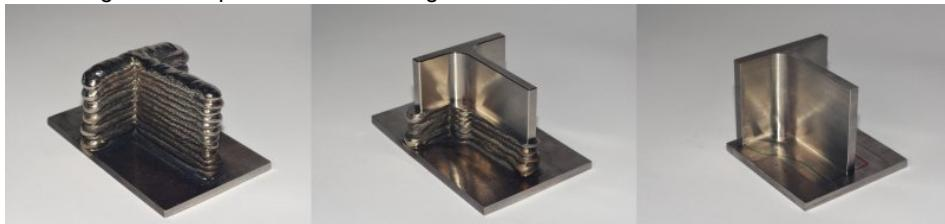
Mit »Wire Arc Additive Manufacturing« werden Bauteile Schicht für Schicht aufgebaut (Bild: Fronius).
