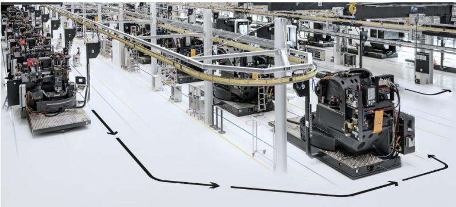
Die Fließmontage mit 34 AGVs steigert die Produktivität um 30 % (Bild: DMG Mori).
