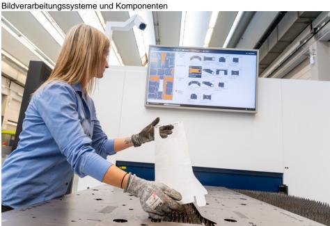
KI unterstützt bei der Entnahme lasergeschnittener Blechbauteile (Bild: Trumpf).
