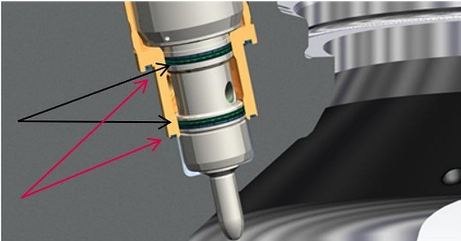
Das Verfahren wird z.B. bei Ventilkomponenten aus ferritischem Edelstahl eingesetzt, die traditionell hartverchromt wurden (Bild: Expanite).
