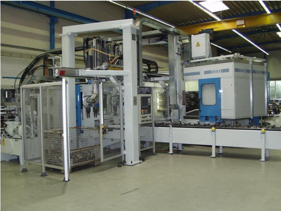
Die Rundtaktmaschine mit Doppelspindel, Einlegestation und vier Bearbeitungsstationen (Bild: SSB).
