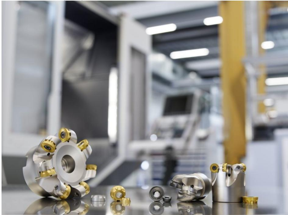
Die Rundwendeplatten erlauben ein schnelles, präzises Indexieren und verbleiben verdreh sicher im Plattensitz (Bild: Seco Tools).
