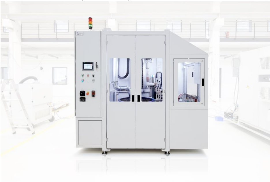
Streamfinish-Maschine zur Kantenverrundung unterschiedlicher Hartmetallwerkzeuge (Bild: Otec Präzisionsfinish).
