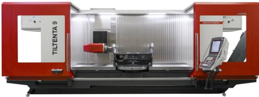
Große Werkstücke mit einem Störkreisdurchmesser bis 1450 mm können stirnseitig bearbeitet werden (Bild: Hedelius).
