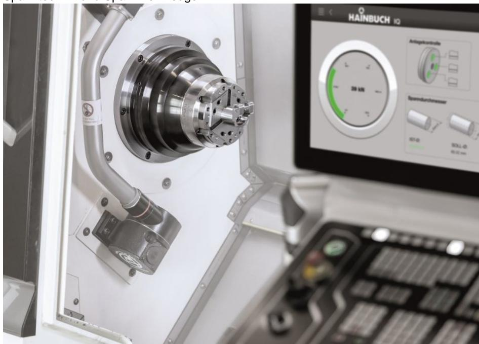
Mit den integrierten Sensoren ermöglicht das Spannsystem die Realisierung von Condition-Monitoring-Konzepten (Bild: Hainbuch).
