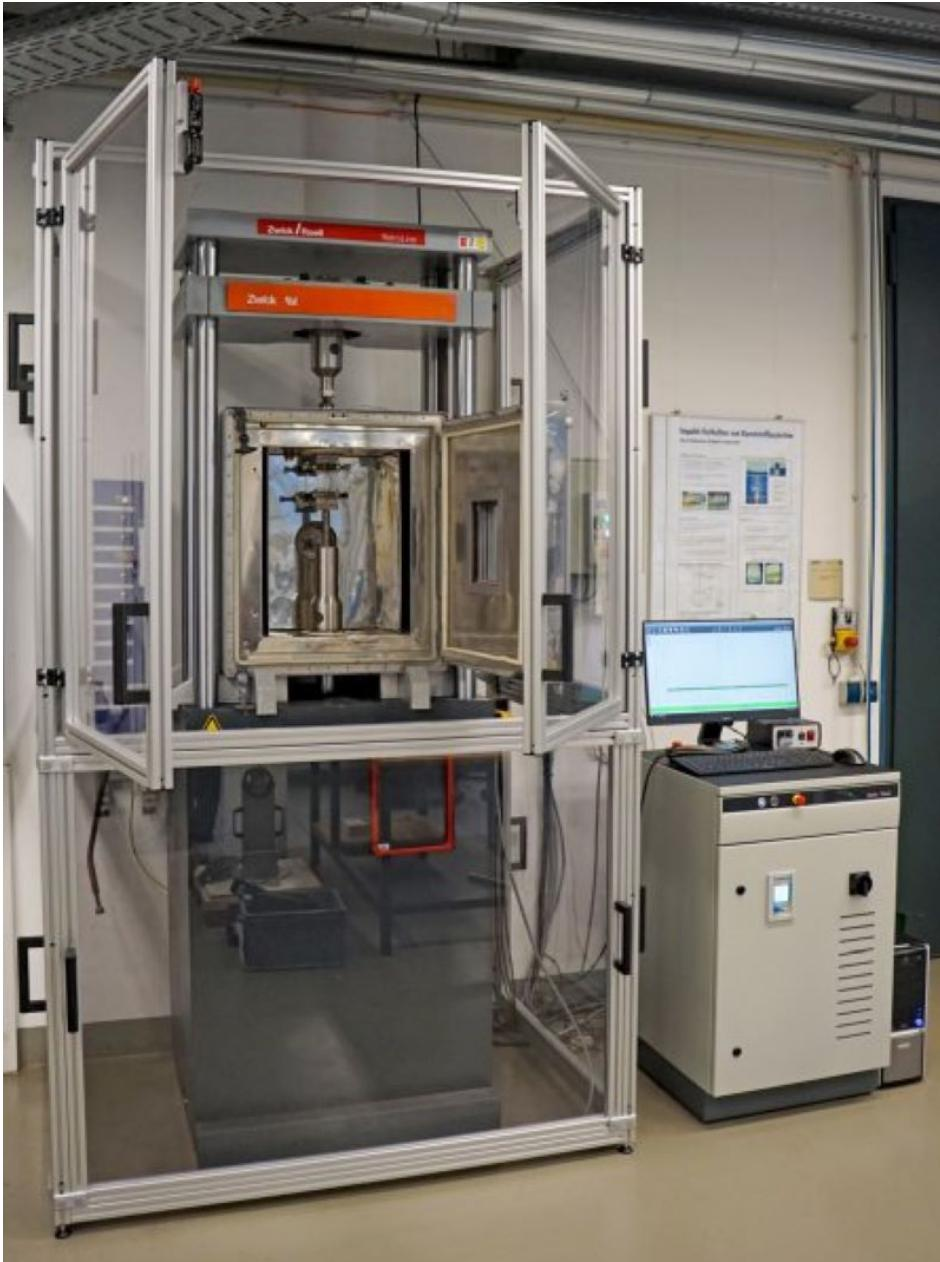
Die hydraulisch betriebene Prüfmaschine wurde elektrifiziert und mit einer neuen Steuerung versehen (Bild: ZwickRoell).
