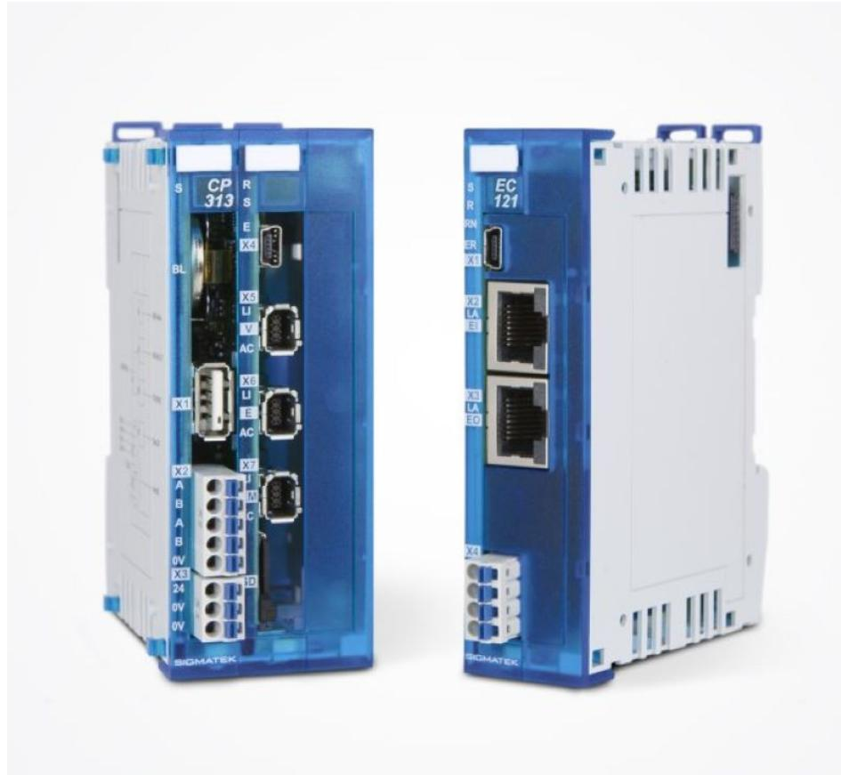
CPU-Modul (li.) und Anschaltmodul erweitern das Echtzeit-Ethernet-Portfolio des kompakten Steuerungssystems (Bild: Sigmatek).
