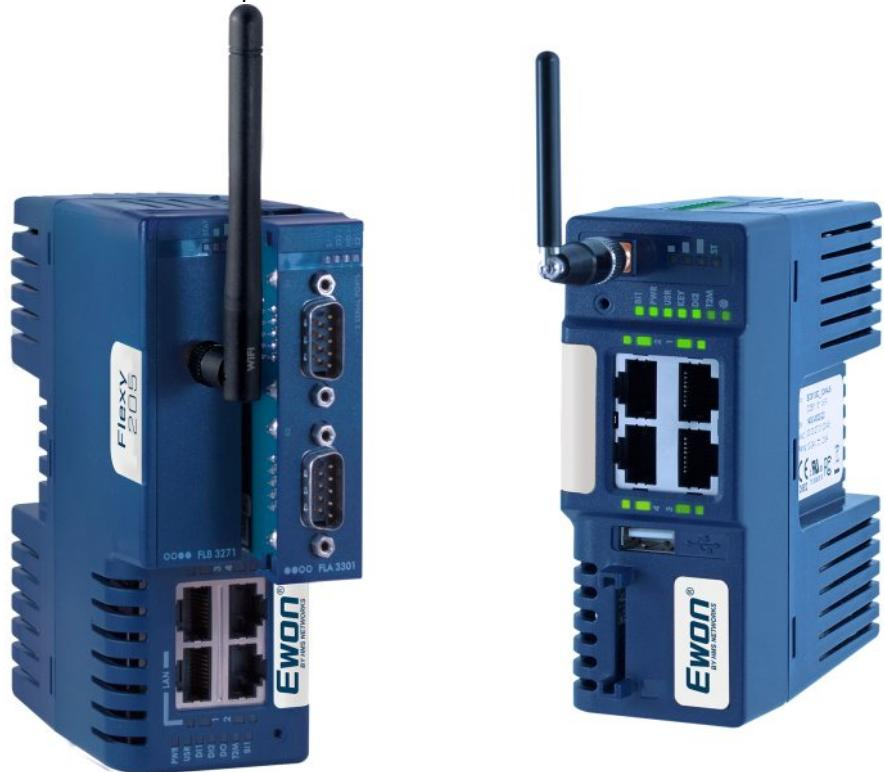
VPN-Router für einen einfachen und sicheren Fernzugriff auf die Maschine (Bild: HMS Industrial Networks).
