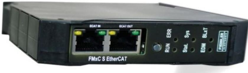
Mit der neuen Feldbuserweiterung wird die Sicherheitssteuerung Ethercat-fähig (Bild: Fiessler Elektronik).
