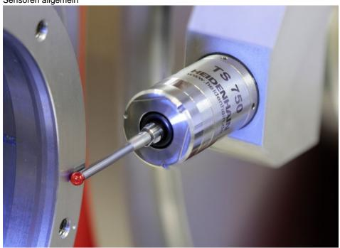
Ein sehr genaues Werkstück-Tastsystem für Schleifmaschinen ist das neue »TS 750« (Bild: Heidenhain).
