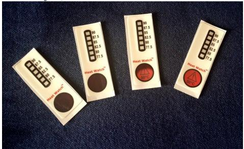
Die Temperaturmessstreifen »Heat Watch« haben einen reversiblen und irreversiblen Messbereich (Bild: Kager).
