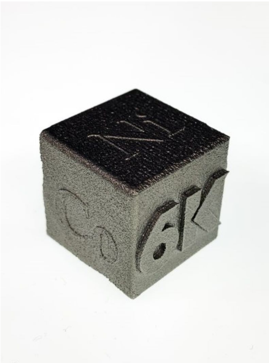
Gemeinsam fertigen Castheon und 6K ein 3D-gedrucktes Hochentropielegierungsteil (Bild: 6K).
