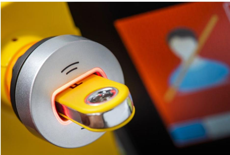
Das Maschinenbedienpersonal erhält eine individuelle Zugangsberechtigung auf dem RFID-Transponderschlüssel. Der farbige LED-Ring an der Ausleseeinheit signalisiert, ob die für die ausgewählte Aufgabe an der Anlage erforderliche Autorisierung vorliegt oder nicht (Bild: Pilz).
