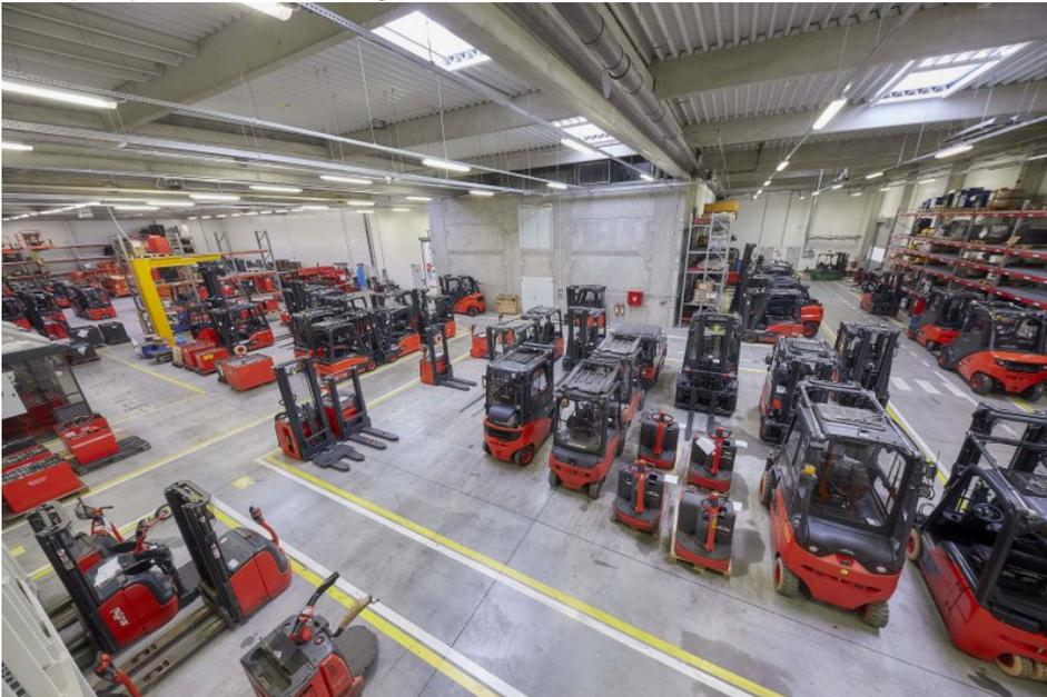
Im erweiterten Aufbereitungswerk für Gebrauchstapler sollen pro Jahr bis zu 2000 Geräte aufbereitet werden (Bild: Linde Material Handling).
