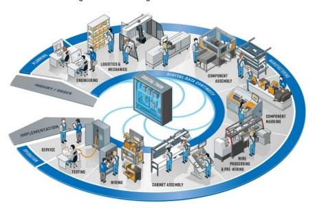
Von der Komponentenauswahl über die Vorfertigung von Kabelsätzen, Betriebsmitteln und Gehäusen bis hin zur assistierten Endmontage und Prüfung vor der Inbetriebnahme wollen die Partner das komplette Angebot abdecken (Grafik: Weidmüller).
