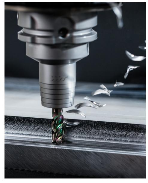
Mit ihrer optimierten Beschichtung und Geometrie werden die Fräser für die Bearbeitung von Aluminium und NE-Metallen empfohlen. Bild: Ceratizit
