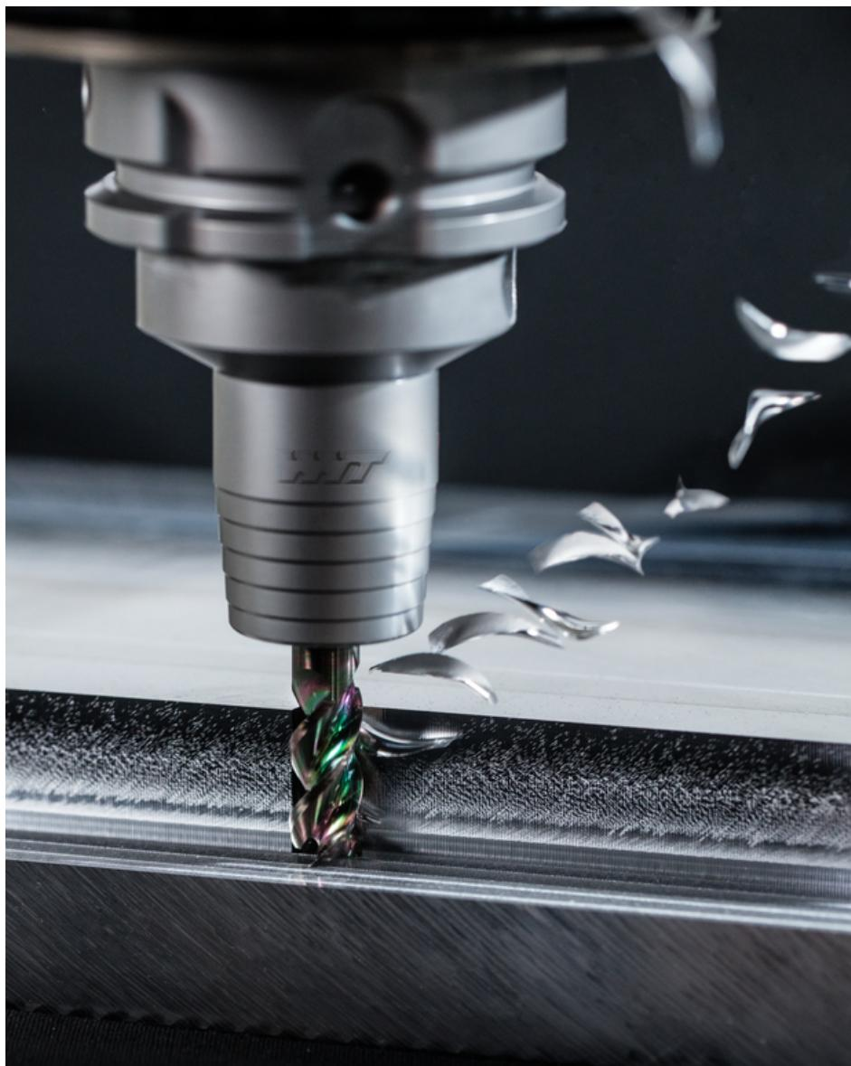
Mit ihrer optimierten Beschichtung und Geometrie werden die Fräser für die Bearbeitung von Aluminium und NE-Metallen empfohlen. Bild: Ceratizit
