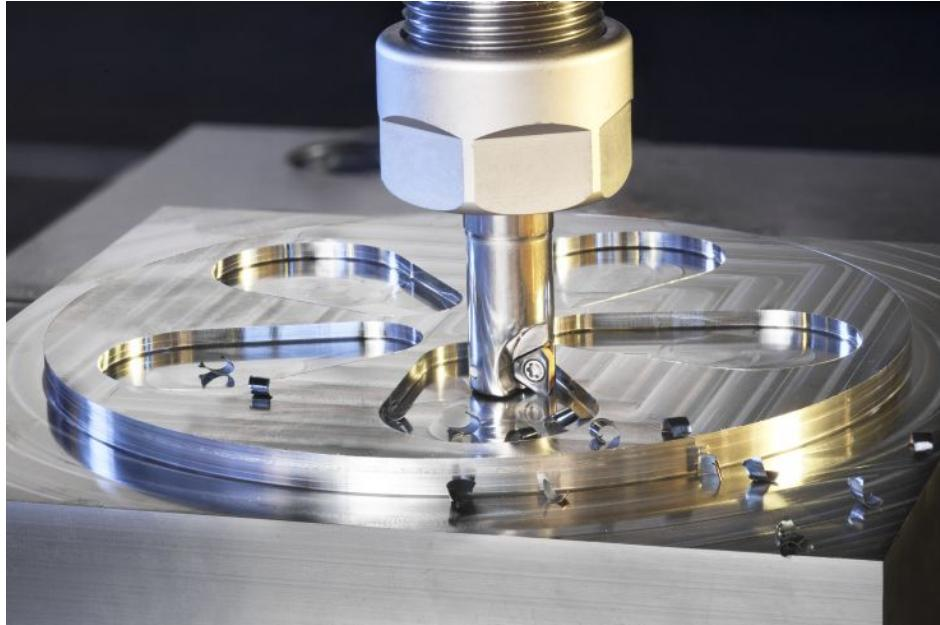
Der kleine 90-Grad-Schaftfräser ist dank hochpositivem Spanwinkel extrem weichschneidend. Bild: Iscar
