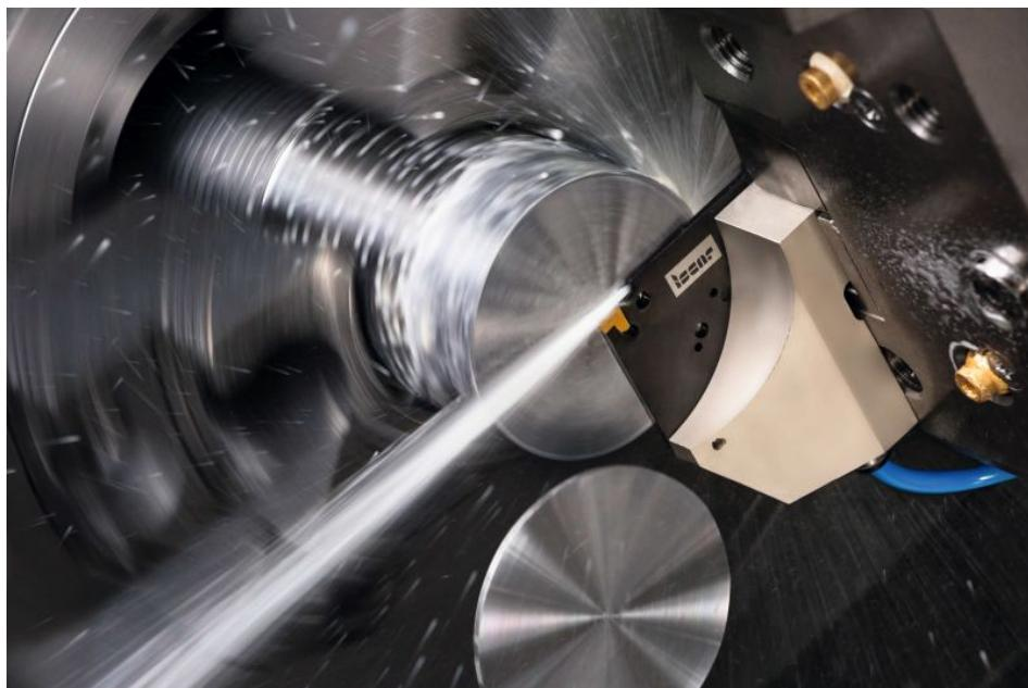
Aufgrund seiner robusten Konstruktion sorgt der neue Werkzeughalter für vibrationsfreies Abstechen. Bild: Iscar
