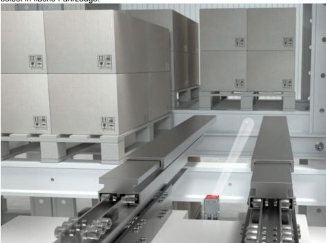
achfeinpositionierung - doppeltiefe Positionierung. Bild: Leuze
