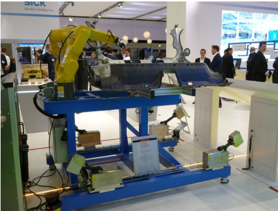
Das berührungslose Lokalisierungssystem auf der SPS 2019. Bild: Kuhn
