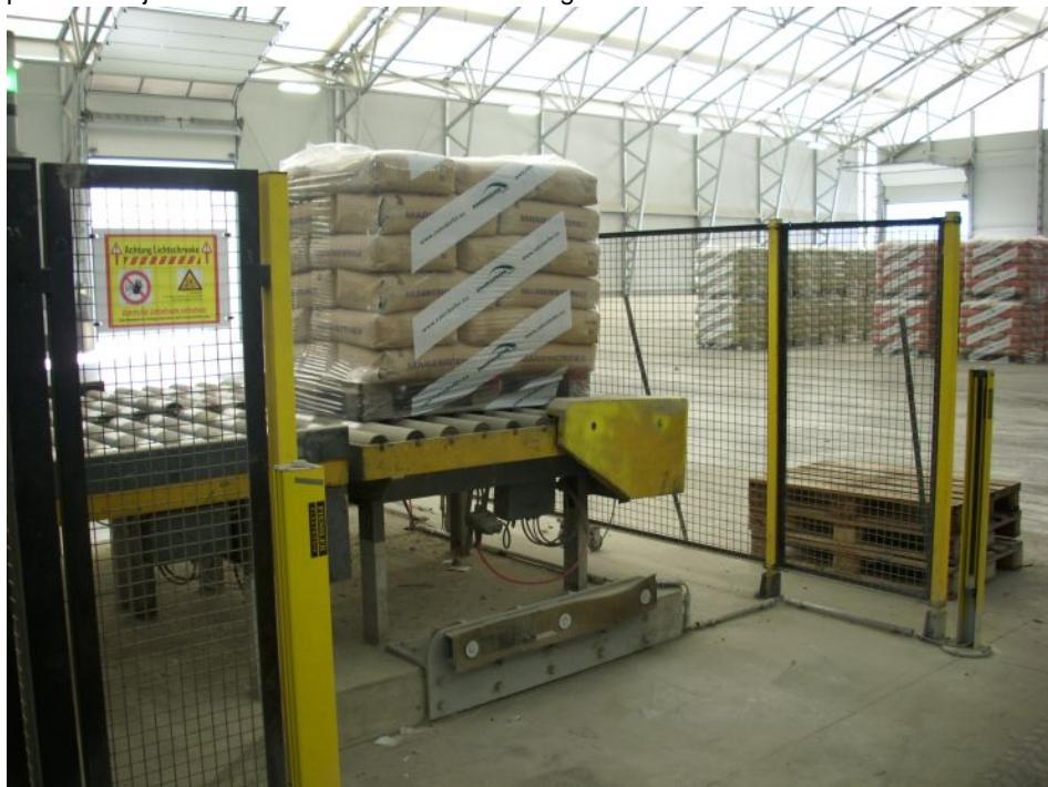
Auch die Abnahmestation kann der Gabelstapler ohne Unterbrechung der Anlage anfahren. Bild: Fiessler
