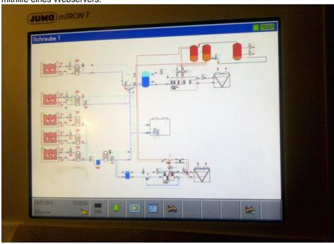
Das Multifunktionspanel ermöglicht neben der Visualisierung auch die komfortable Bedienung der Regler und Programmgeber. Bild: Jumo
