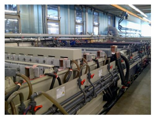
Beim Eloxieren kommt der effizient gesteuerten Kühlung der Säurebäder eine große Bedeutung zu. Bild: Jumo
