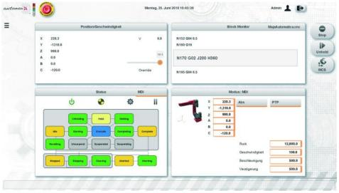
Die mit »mapp View« erstellte Bedienerschnittstelle für den Roboter-Showcase basiert auf moderner Web-Technik und lässt sich mit jedem browserfähigen Gerät aufrufen. Bild: B&R
