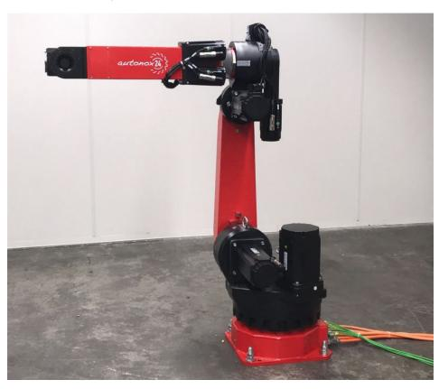
Majatronic bietet jetzt auch steuerungsunabhängige 6-Achs-Knickarmroboter, die sich problemlos in B&R-Maschinensteuerungen integrieren lassen. Bild: Majatronic
