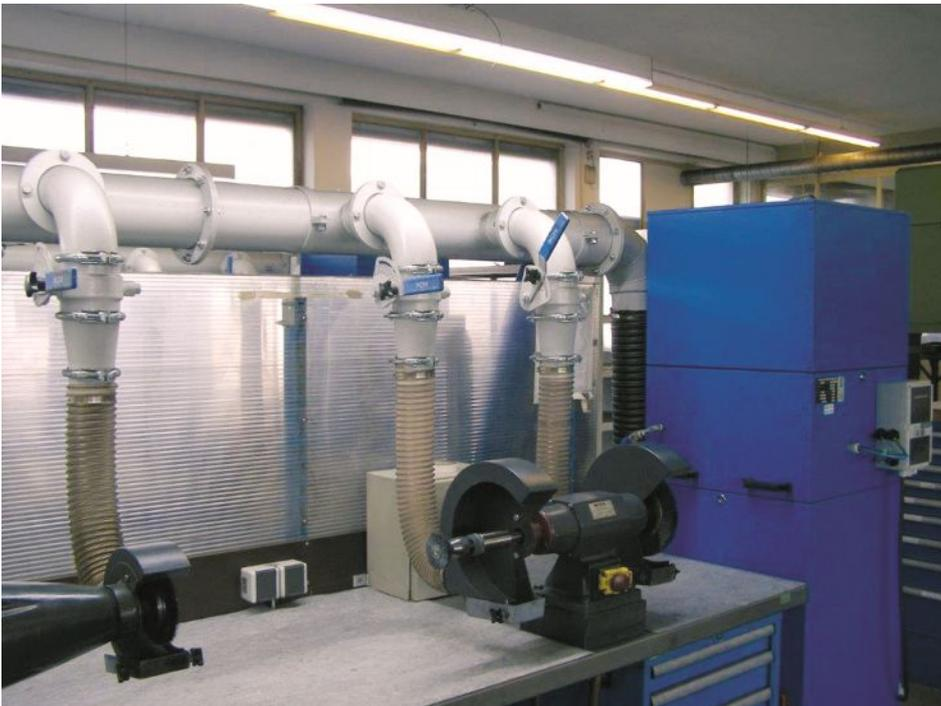
Büchel passte die Absaugvorrichtungen für die Entgratstationen bei der SPN Schwaben Präzision genau an die Tische und Maschinen an, sodass der Staub bestmöglich erfasst werden kann. Bild: Büchel
