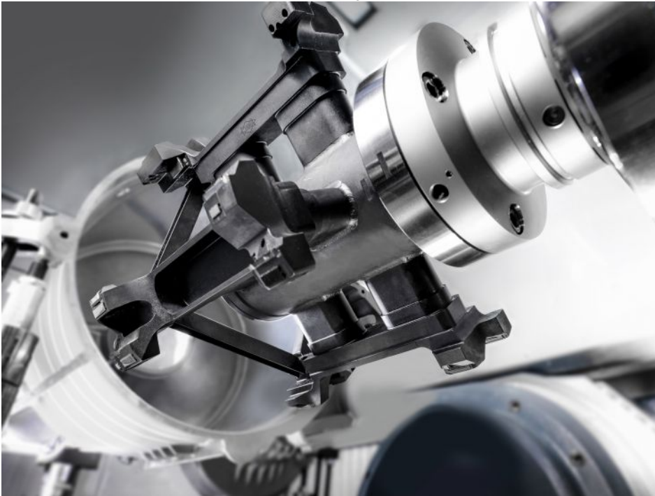
Um die Hauptbohrung des Statorgehäuses mikrometergenau zu fertigen, wird sie mit einem Feinbohrwerkzeug bearbeitet. Bild: Heller
