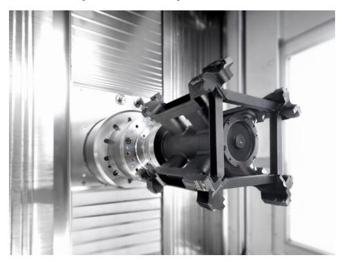
Das von Mapal entwickelte Werkzeug überzeugt unter anderem durch sein niedriges Gewicht sowie die feinjustierbaren PKD-Schneiden. Bild: Heller
