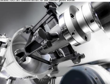
Um die Hauptbohrung des Statorgehäuses mikrometergenau zu fertigen, wird sie mit einem Feinbohrwerkzeug bearbeitet. Bild: Heller
