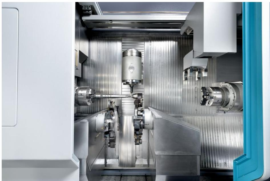
Das neue Dreh-Fräszentrum von Index bietet optional die Integration einer 2-Achsen-Handhabungseinheit für das Be- und Entladen sowie Reststückentnahme bis zu einem Teilegewicht von 20 Kilogramm. Bild: Index-Werke
