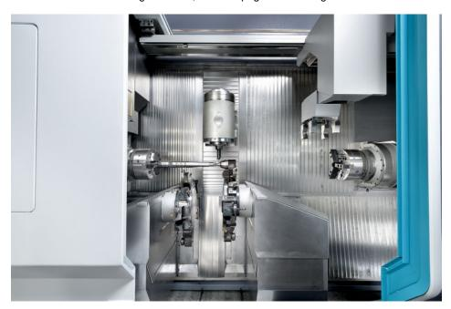
Das neue Dreh-Fräszentrum von Index bietet optional die Integration einer 2-Achs-Handhabungseinheit für das Be- und Entladen sowie Reststückentnahme bis zu einem Teilegewicht von 20 Kilogramm. Bild: Index-Werke
