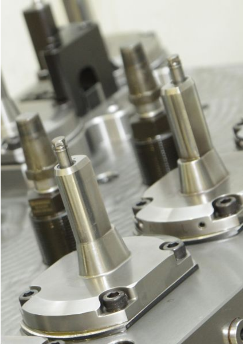
Bohrungsspanner mit verlängerter Werkstückauflage und integrierter
