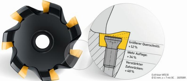
Am Fräskörper selbst ergibt sich durch den kleineren Freiwinkel die Möglichkeit, den Zahnrücken um 40 Prozent zu verstärken. Bild: Walter AG
